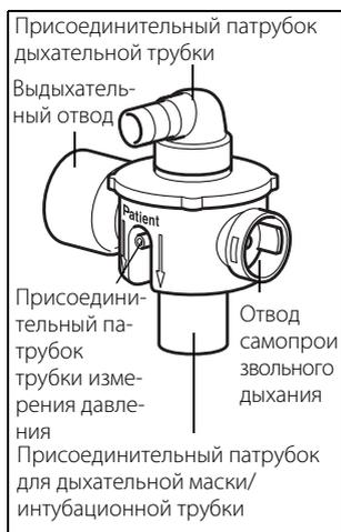
Через систему трубок пациента с клапаном пациента газ для искусственной вентиляции подается к пациенту. Благодаря особой конструкции системы трубок пациента с клапаном пациента даже при выходе из строя аппарата искусственной вентиляции легких возможно самопроизвольное дыхание независимо от того, какой режим искусственной вентиляции легких выбран вами.
