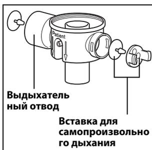
1. Выньте вставку для самопроизвольного дыхания из клапана пациента. Для этого отожмите, например, маленькой отверткой, оба фиксатора из гнезда.
